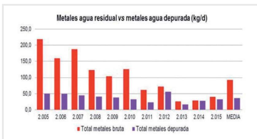
Figura-2: Evolución de la cantidad total de metales pesados estudiados (2.005-15) en agua residual bruta y depurada (EDAR La Golondrina-Córdoba): arriba concentración, debajo carga
