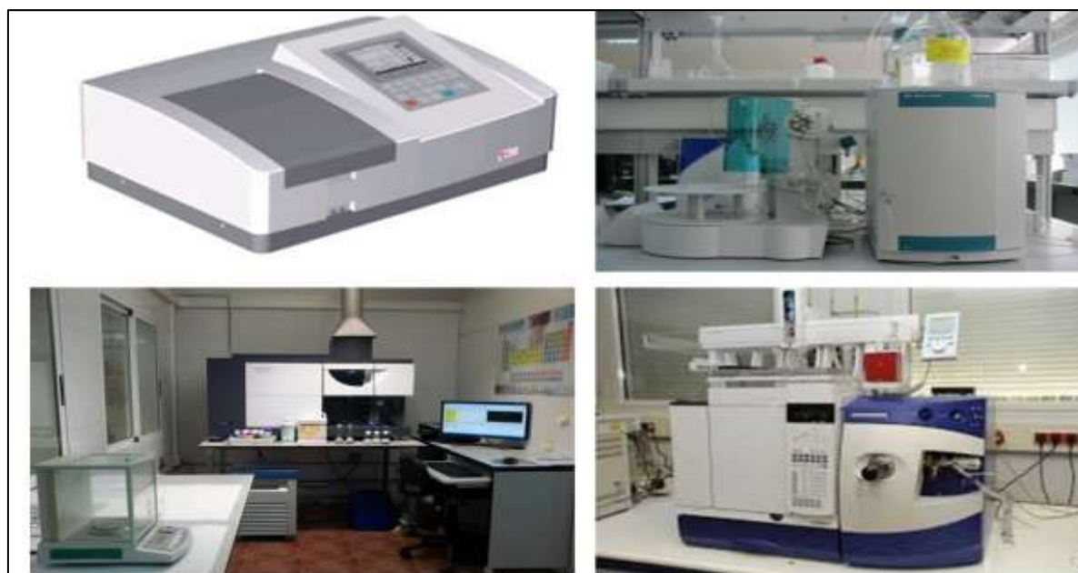
Figura 3: Izda. arriba, espectrofotómetro UV-visible; dcha. arriba, cromatógrafo iónico; izda. debajo, equipo de inducción acoplada de plasma (ICP); dcha. debajo, cromatógrafo de gases. Fuente: Elaboración propia del Autor. Ponencia en Jornada sobre reutilización de aguas regeneradas en el País Vasco (2017).
