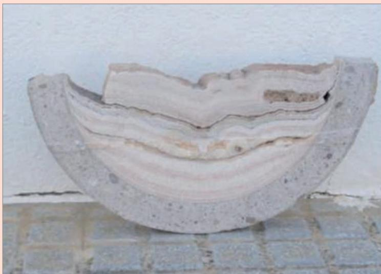
Figura 4. Conducción de agua con deposiciones calcáreas debidas al efecto de aguas incrustantes (precipitación de  $\text{CaCO}_3$  y otros materiales asociados).
