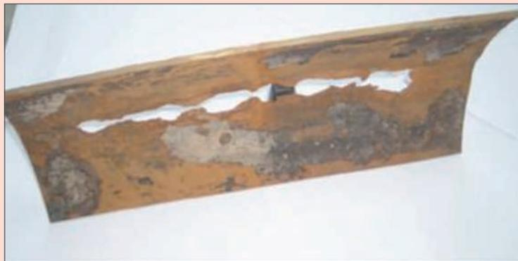
Figura 1. Trozo de tubería metálica severamente corroída mostrando zonas totalmente perforadas.
