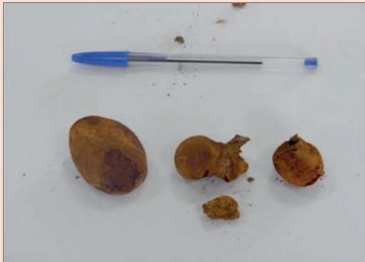
Figura 8. Tubérculos típicos de corrosión bacteriana en tuberías de hierro.
