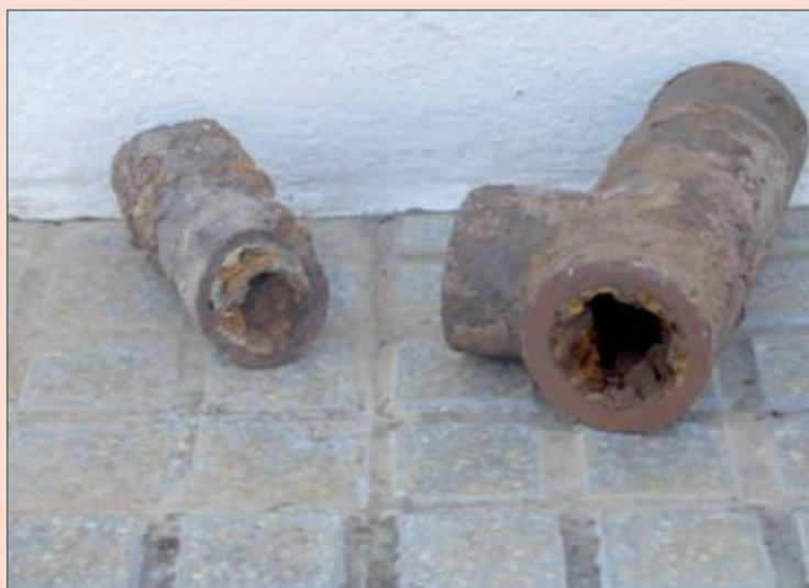
Figura 3. Corrosión electroquímica inter na y exter na en tuberías de fundición de hierro. Obsérvense tanto picaduras y perforaciones como acumulaciones de depósitos.
