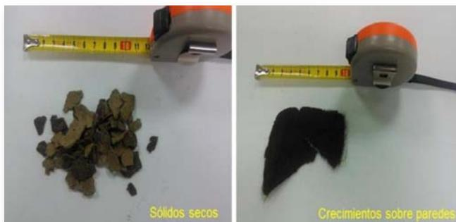
Fotografía 6: Sólidos retirados del fondo del DAB, izqda.; crecimientos algales en paredes, dcha.
