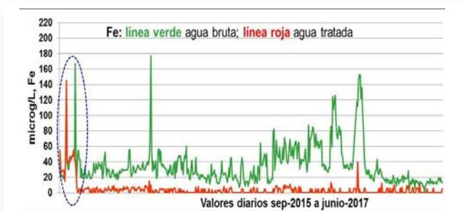
Figura 4: Evolución de hierro en entrada a DAB vs. salida agua tratada en la ETAP.
