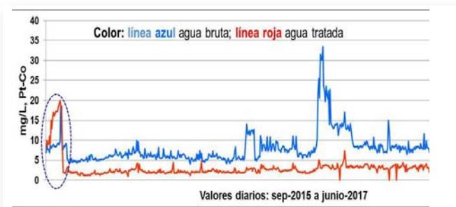
Figura 2: Evolución de color en entrada a DAB vs. salida agua tratada en la ETAP.
