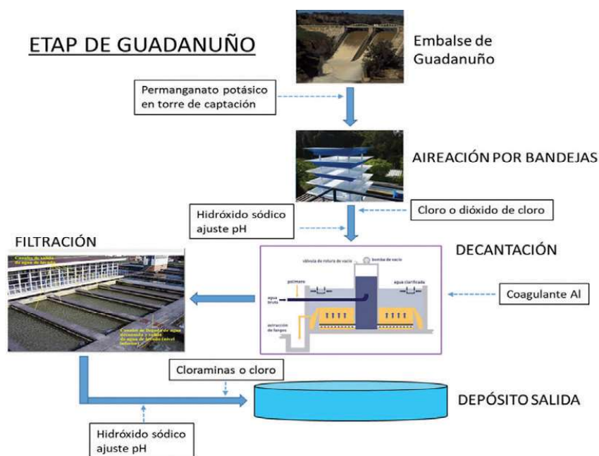
Figura 4: Esquema de la ETAP de Guadalupe: línea de tratamiento.
