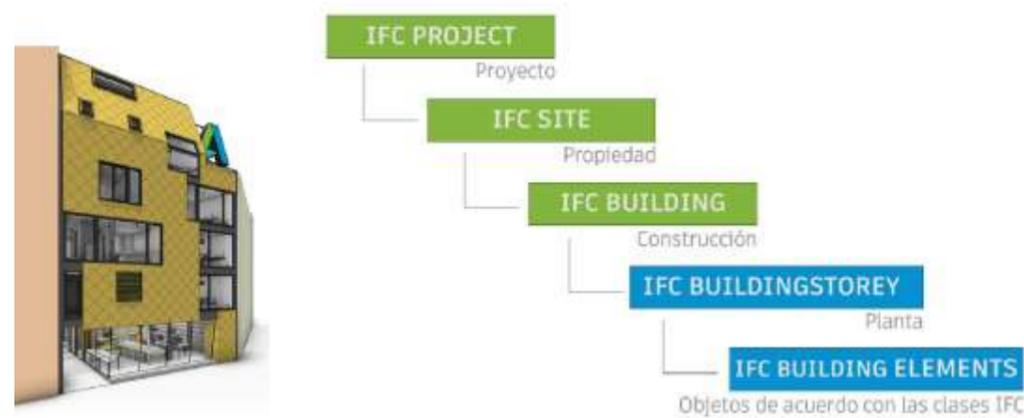
Fig. 08 Estructura de árbol de IFC. Manual de IFC para Revit. Autodesk
