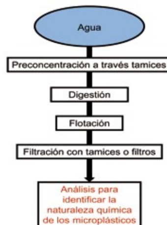
FIGURA 4. Proceso de investigación clásica de microplásticos en aguas.
